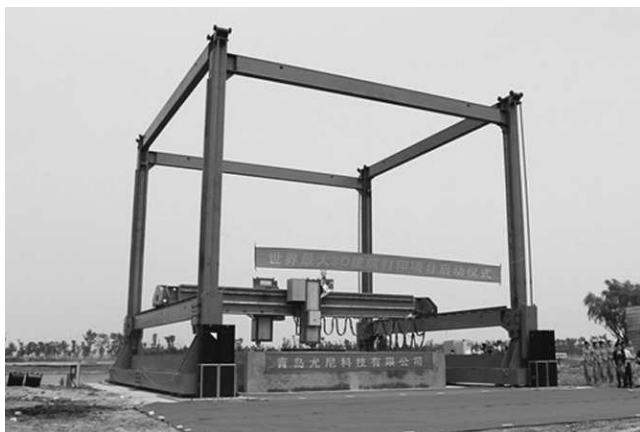
Один из 3d-принтеров, построенных и используемых в Китае для печати комнат жилых домов.
