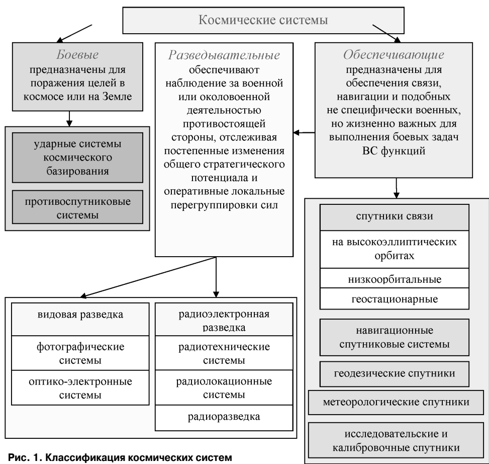
Рис. 1. Классификация космических систем по характеру выполняемых функций.
